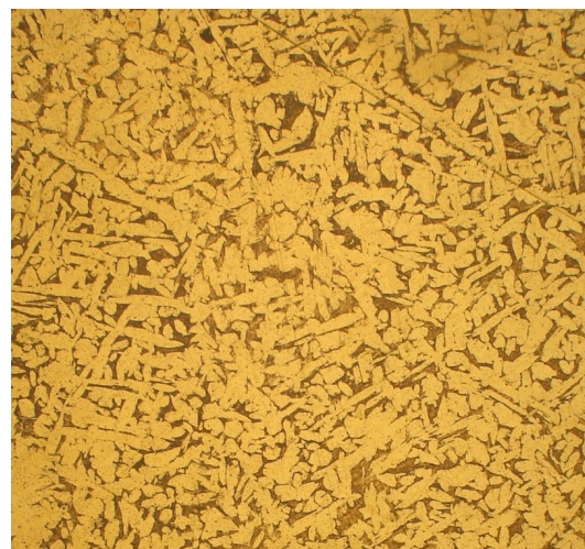
Fig. 5. Alloy microstructure CuAl9Fe3V.
