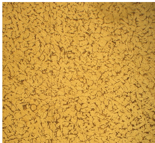
Fig. 3. Alloy microstructure CuAl9Fe3Mo.
