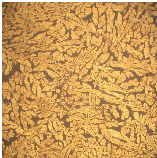
Fig.1. Base alloy microstructure CuAl9.
