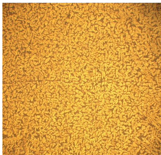
Fig.2. Base alloy microstructure CuAl9Fe3.
