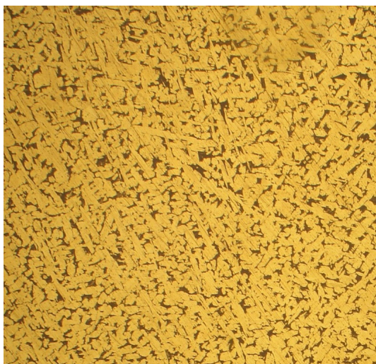
Fig. 4. Alloy microstructure CuAl9Fe3W.
