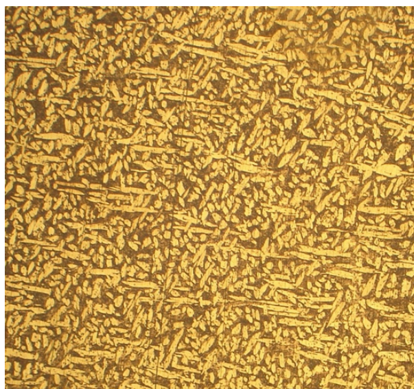
Fig. 4. Alloy microstructure CuAl9Fe3Zr ( \times 63 ).
