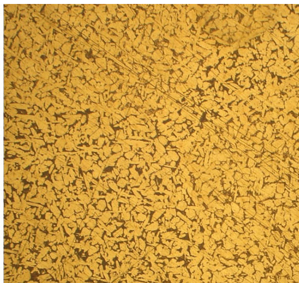
Fig. 5. Alloy microstructure CuAl9Fe3 Ti ( \times 63 ).
