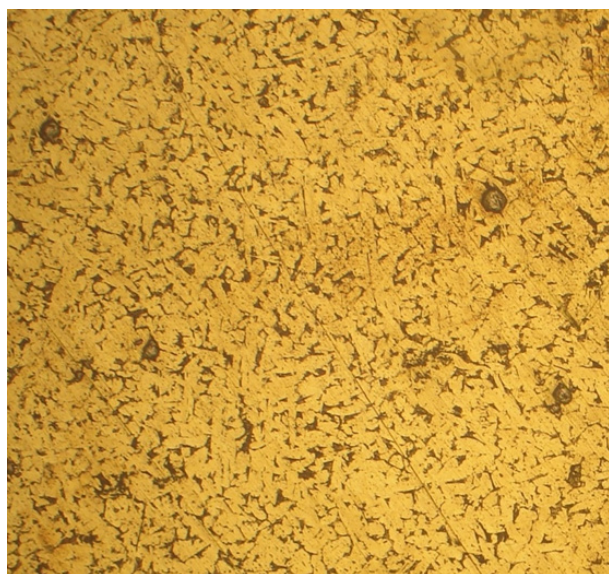
Fig. 3. Alloy microstructure CuAl9Fe3B ( \times 63 ).
